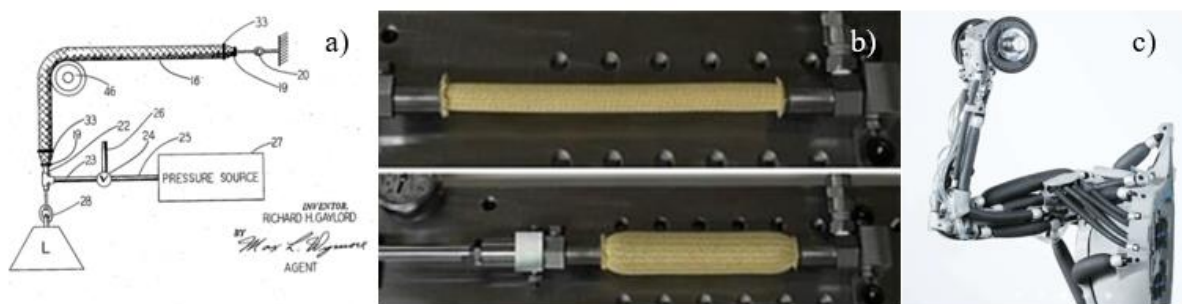
4. ábra McKibben-féle mesterséges izomizom. a) Az eredeti szabadalomban szereplő egyik ábra. Az ábra az aktuátor emelőként való használati lehetőségét mutatja (Gaylord, 1958), b) a Bridgestone által kifejlesztett Rubbertuator nevű McKibben-féle mesterséges izom (Bridgestone, 2017), c) Egy modern alkalmazás: Festo Airic's arm aminek mozgását McKibben-féle mesterséges izmok végzik (Festo, 2022).
