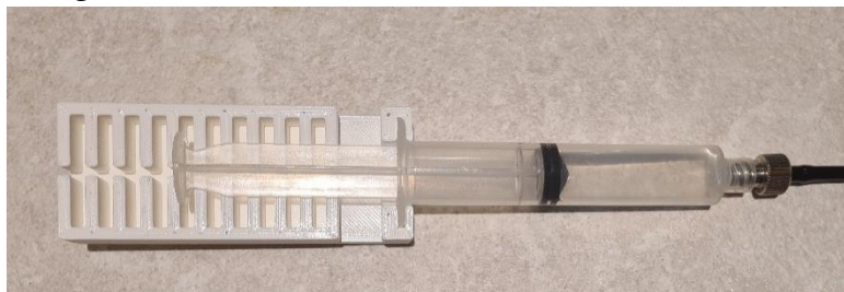
17. ábra – Az általam tervezett állandó térfogatot biztosító 3D nyomtatott alkatrész. A képen látható konfiguráció 4 mL többlettérfogatot eredményez.
