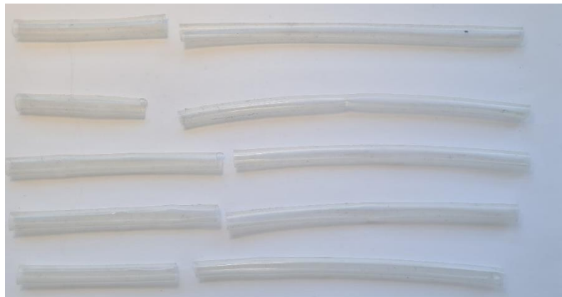
36. ábra A szilikon próbatestek szakítás után – a vizsgált darabok visszanyerték áttetszőségüket. A képen látható csövek külső átmérője 8 mm.
