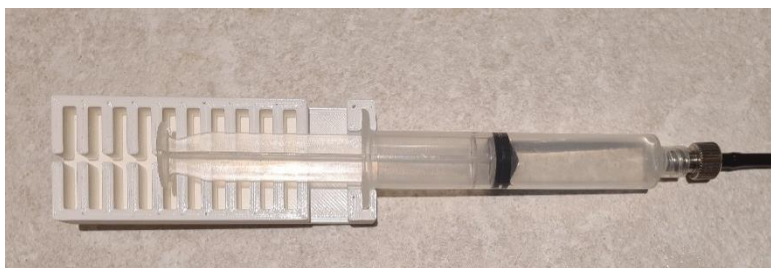
13. ábra – Az általam tervezett állandó térfogatot biztosító 3D nyomtatott alkatrész. A képen látható konfiguráció 4 mL többlettérfogatot eredményez.
