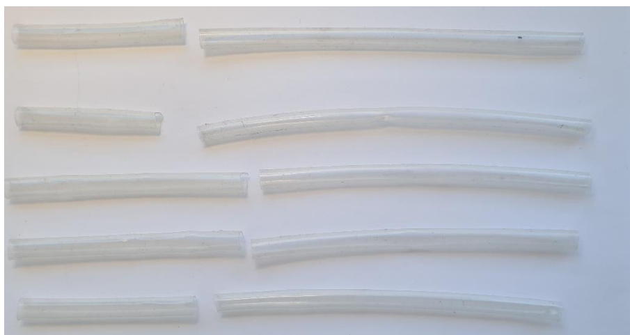
24. ábra szilikon próbatestek szakítás után – A vizsgált darabok visszanyerték áttetszőségüket. A képen látható csövek külső átmérője 8 mm.
