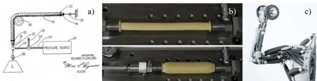
4. ábra McKibben-féle mesterséges izomizom. a) Az eredeti szabadalomban szereplő egyik ábra. Az ábra az aktuátor emelőként való használati lehetőségét mutatja [8], b) Bridgestone által kifejlesztett Rubbertuator nevű McKibben-féle mesterséges izom [9], c) Egy modern alkalmazás: Festo Airic's arm aminek a mozgását McKibben féle mesterséges izmok végzik [10].
