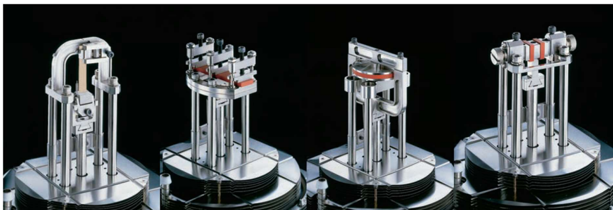
2. ábra Különféle mérőfeltétek (balról-jobbra: húzó, hajlító, nyomó és nyíró) [6]
