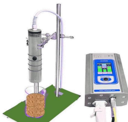
19. ábra: Ultrahanggal segített extrakció mérési elrendezése
