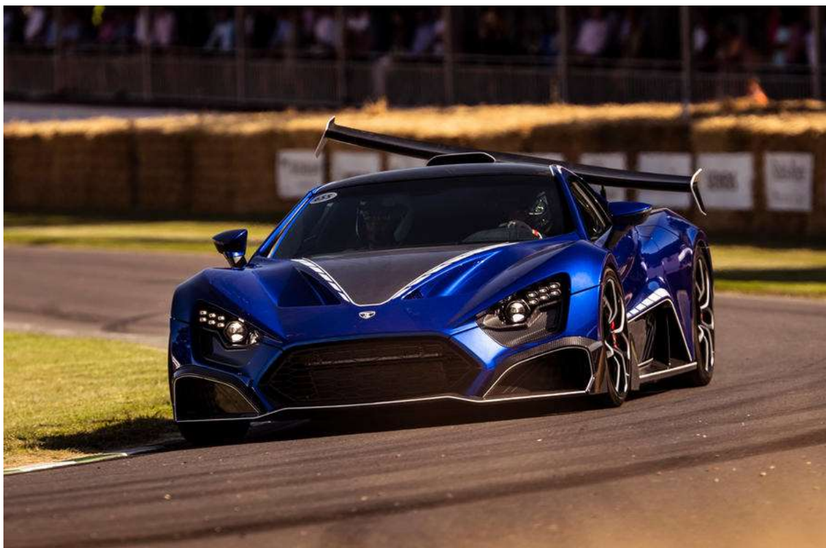
7. ábra: A Zenvo TSR-S aktív hátsó szárnya működés közben a valóságban
