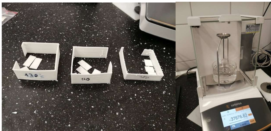
4. ábra Sűrűségmérés során mért minták és a sűrűségmérő feltét
