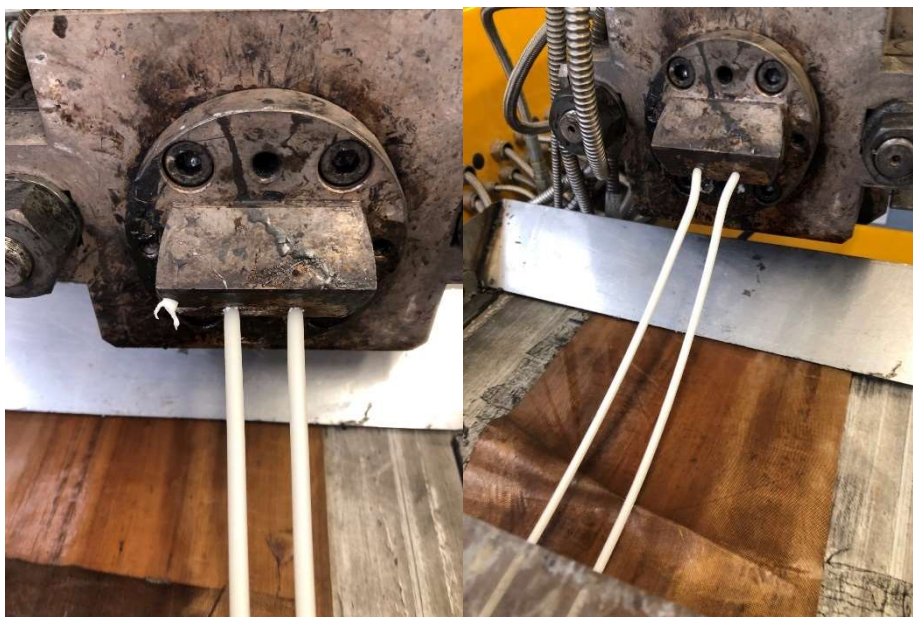
6. ábra OLA-val lágyított PLA és mikrogyöngy típusú habképzőszer kompaundálása
