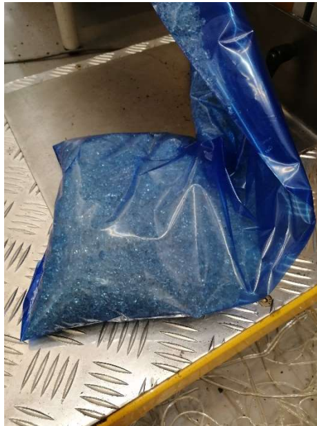
3. ábra Lágyítóval kevert PLA granulátum
