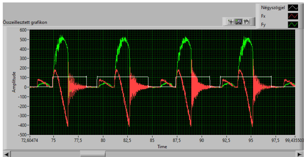
47. ábra: A megmunkálás korai bekezdése miatt adódó hiba
