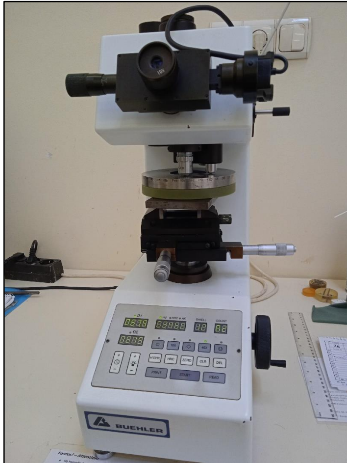
3-5. ábra. A próbatest mikro-keménységmérése
