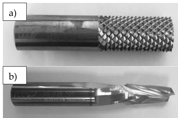
2.6 ábra A brit kutatók által használt szerszámok: a: sokfogú szerszám, b: kompressziós szerszám
