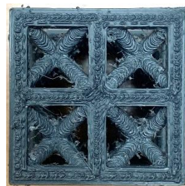
15. ábra. A végleges próbatestek nyomtatási hibáinak bemutatása
