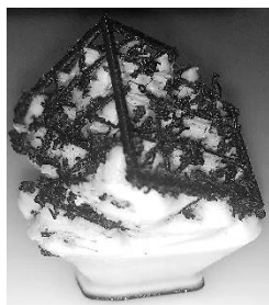
14. ábra. Kezdeti nyomtatási hibák szemléltetése
