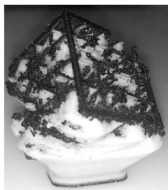
14. ábra. Kezdeti nyomtatási hibák szemléltetése
