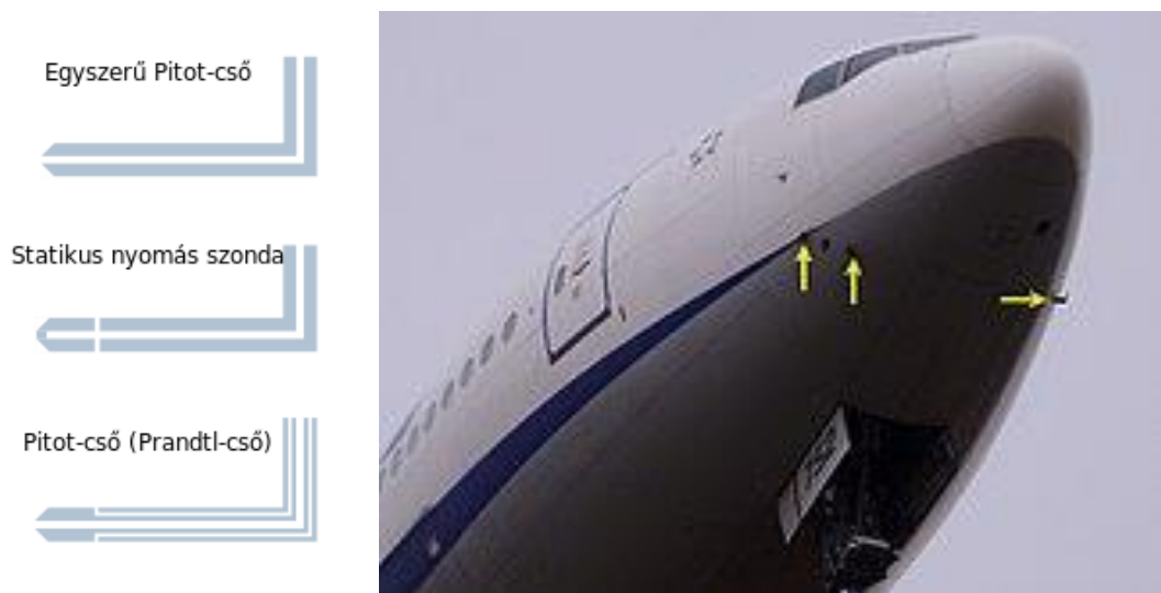
2. ábra. Prandtl és Pitot cső sematikus ábrája (bal oldalon), és egy jellemző felhasználási területük, a repülőgépek (jobb oldalon) [6].
