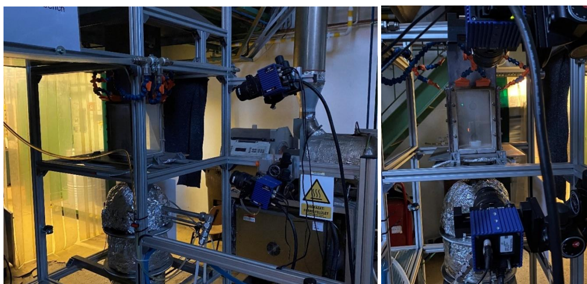
15. ábra. A két kamera (bal) és a kamerák betekintése a tüzelőtérre (jobb).
