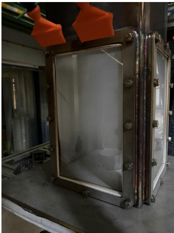
20. ábra. A tűztér kvarc üveglakai, TiO 2 -dal a belső felületükre tapadva.
