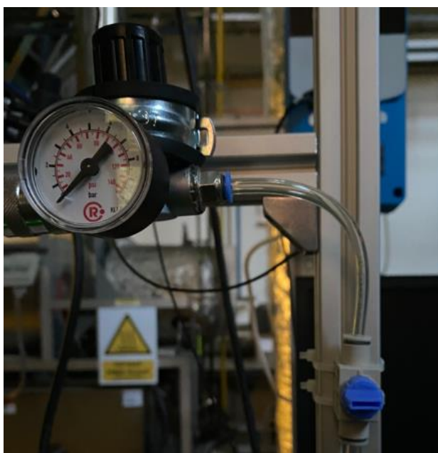
22. ábra. A \text{TiO}_2 szemcsék kontrollált bejuttatására szolgáló rendszer.
