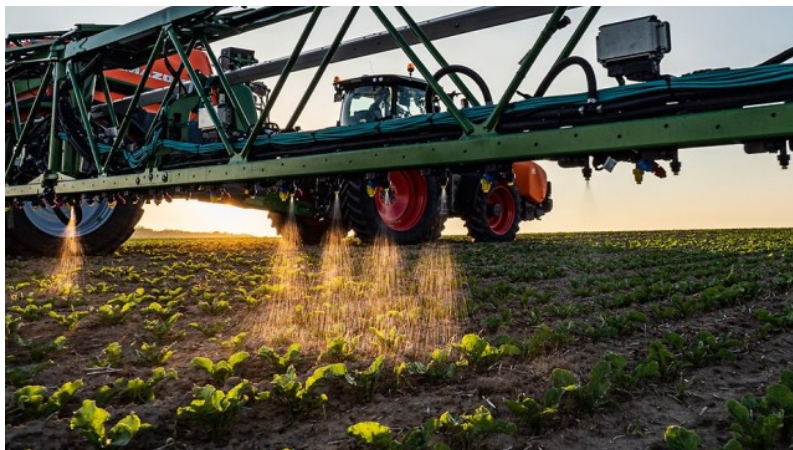
1.7. ábra. Amazone-BASF-Bosch számítógépes látáson alapuló permetezési megoldása (kép forrása: Amazone)
