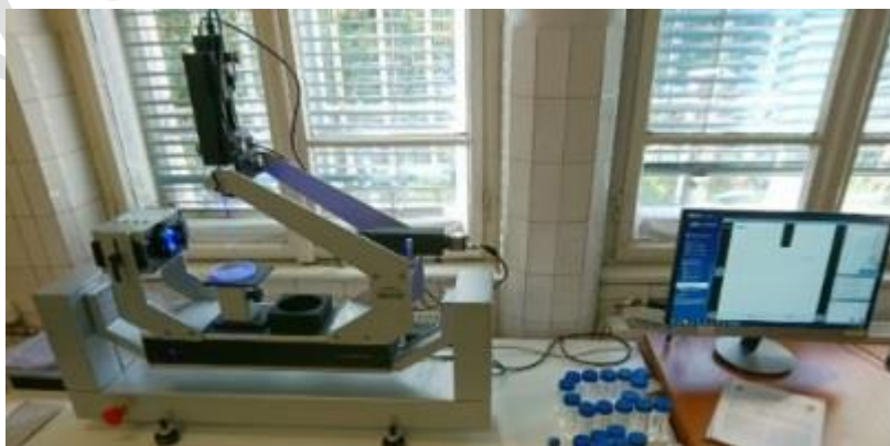
21.ábra: Krüss DSA cseppalak elemző készülék az Élelmiszerkémia és Analitika Tanszék laboratóriumában
