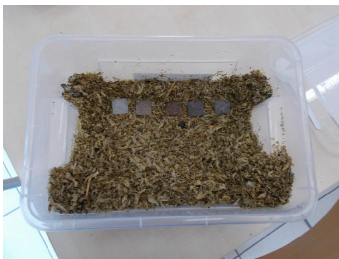
6. ábra Komposztálási vizsgálat kialakítása - reaktor, benne a komposzt, illetve a próbatestek beásásra készen elhelyezve
