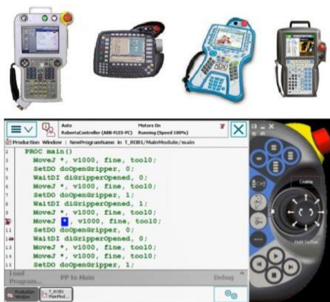
28. ábra Különböző típusú Teach pendant-ek és a Flexpendant virtuális, programozható felülete [23]
