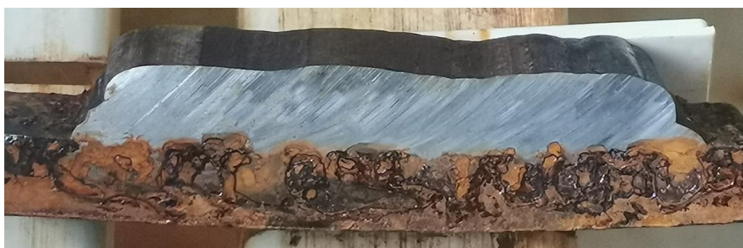
20. ábra: A hegesztett kötés a sópermet vizsgálat után
