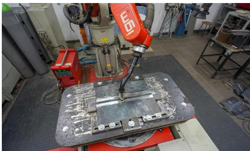
9. ábra: IGM KUKA RTE-4 hegesztőrobot a perifériákkal és a befogóegységekkel
