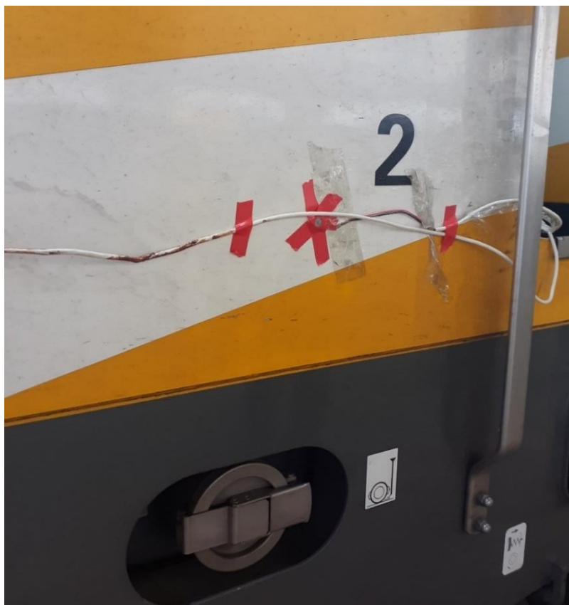
1. melléklet 21. ábra: A jármű oldalán elhelyezett érzékelő
