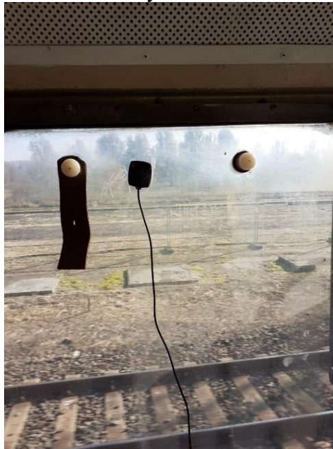
1. melléklet 55. ábra: GPS antenna a V43-as mozdony oldalsó ablakára ragasztva
