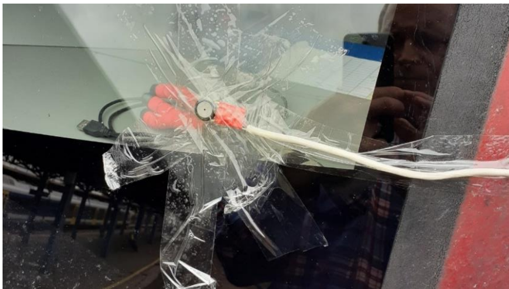
1. melléklet 5. ábra: A szélvédőn elhelyezett érzékelő
