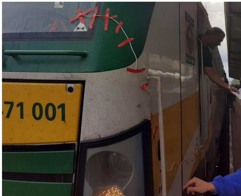
1. melléklet 19. ábra: A járművön elhelyezett érzékelők
