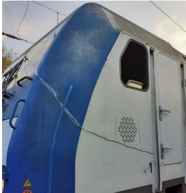
1. melléklet 39. ábra: A járművön elhelyezett érzékelők
