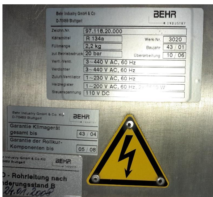
3. melléklet 7. ábra: Taurus mozdony klímaberendezés adattáblája
