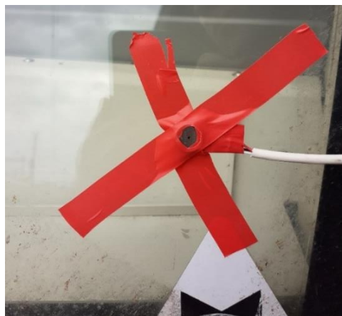
1. melléklet 20. ábra: A szélvédőn elhelyezett érzékelő
