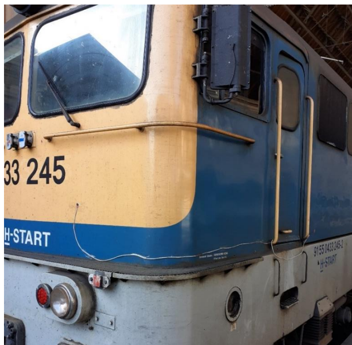
1. melléklet 56. ábra: A járművön elhelyezett érzékelők
