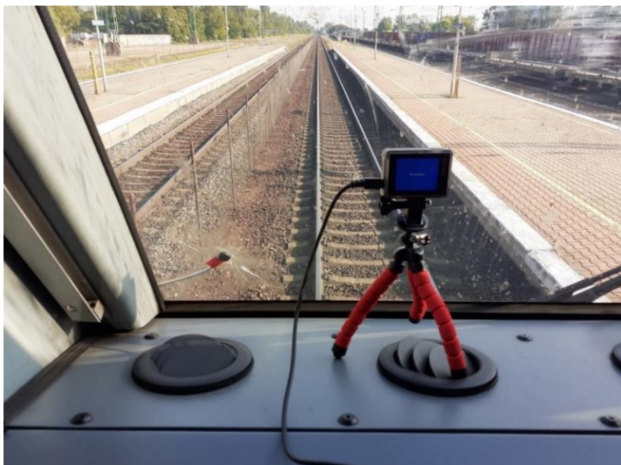
1. melléklet 43. ábra: A szélvédőhöz elhelyezett kamera
