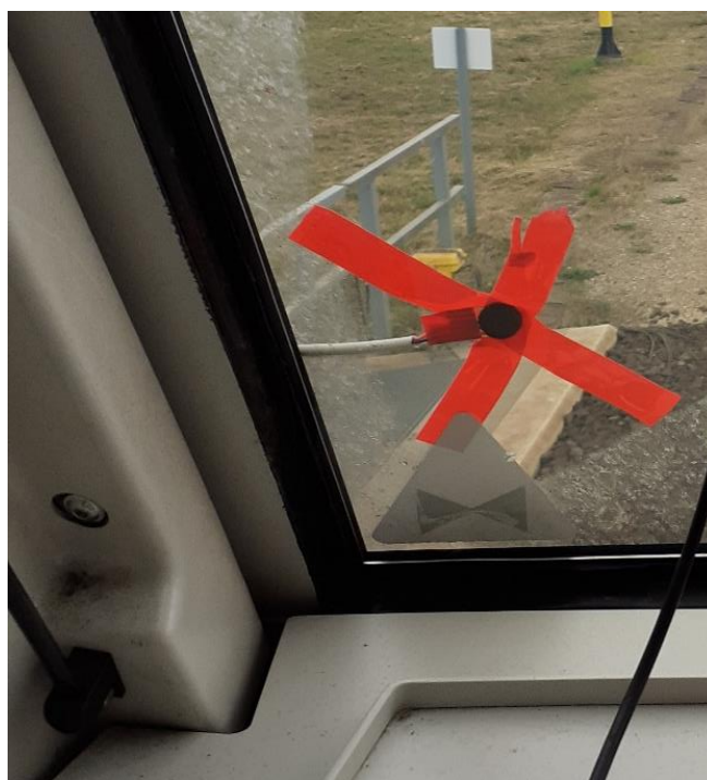
1. melléklet 22. ábra: A szélvédőre elhelyezett szenzor a vezetőállás felől fényképezve
