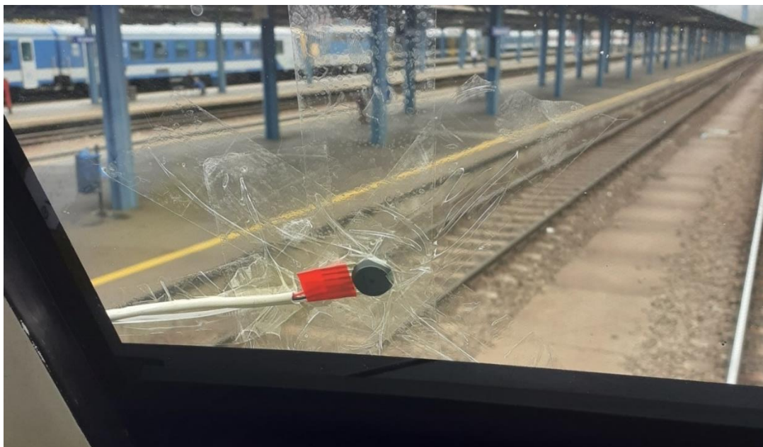
1. melléklet 7. ábra: A szélvédőre elhelyezett szenzor a vezetőállás felől fényképezve
