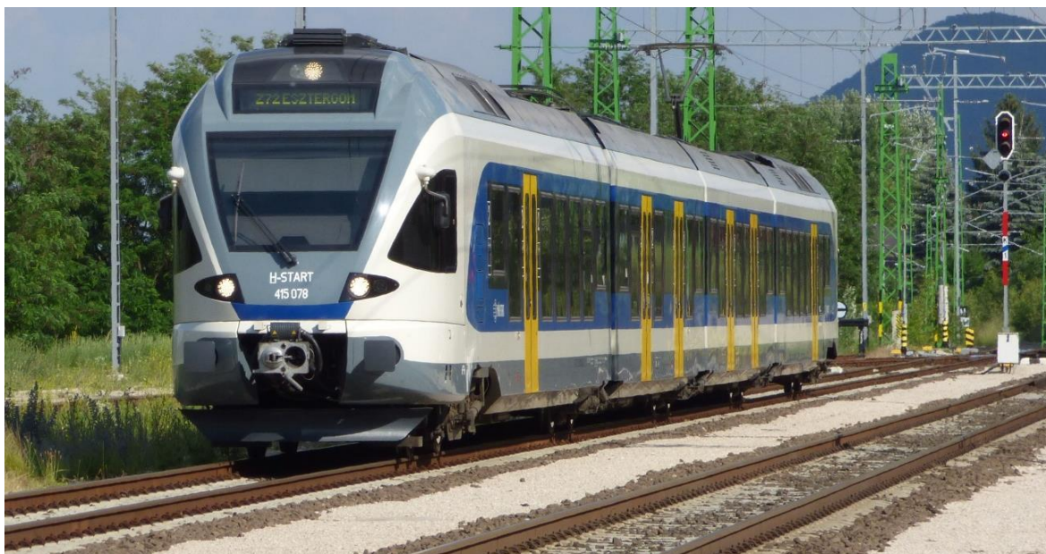
3. melléklet 14. ábra: FLIRT motorvonat
