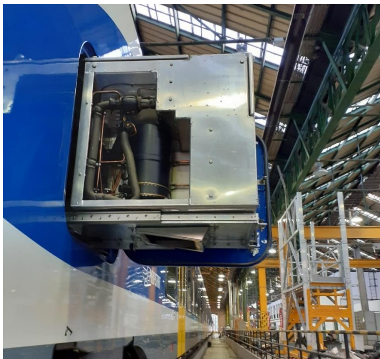
3. melléklet 15. ábra: A klímaegység beépítési helye
