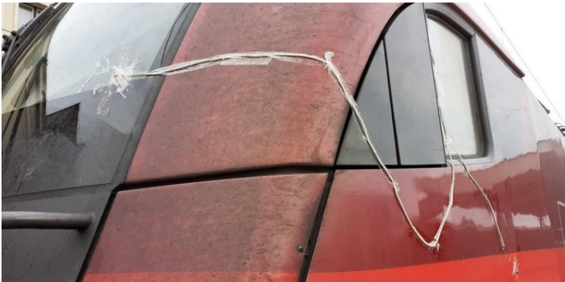
1. melléklet 4. ábra: A járművön elhelyezett érzékelők
