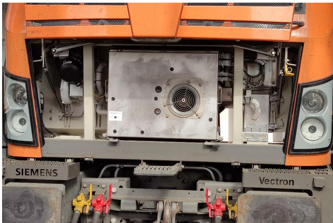
3. melléklet 9. ábra: Vectron mozdony kinyitott orrburkolattal
