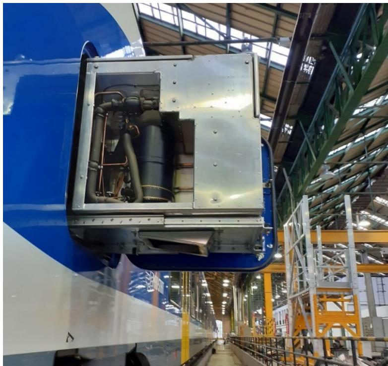
3. melléklet 15. ábra: A klímaegység beépítési helye
