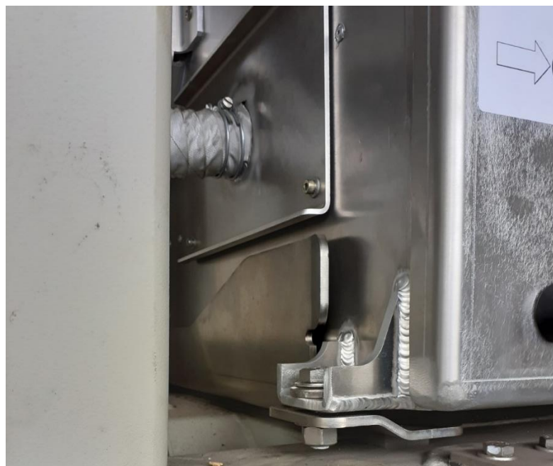
20. ábra: A Vectron klímaegység friss levegő táplálása
