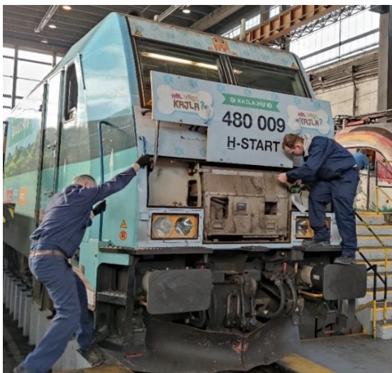
3. ábra: TRAXX mozdony kinyitott orrburkolattal
