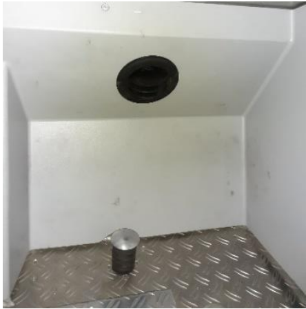
42. ábra: A mozdonyvezető lábára fűjő csatornakivezetés
