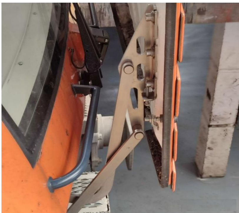
15. ábra: A Vectron mozdony orrburkolatát nyitó szerkezet
