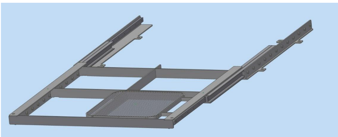
30. ábra: Kihúzott állapotban lévő fióksín a kerettel
