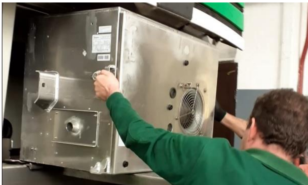
38. ábra: A mozdony klímaberendezésének cseréje
