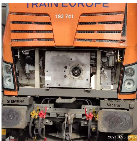
5. ábra: Vectron mozdony kinyitott orrburkolattal
