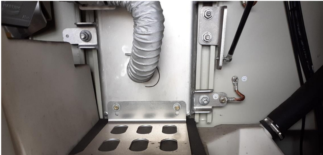
21. ábra: A Vectron klímaegység elhasznált levegő kiszívása
