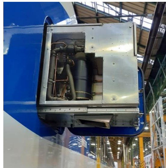
6. ábra: FLIRT motorvonat oldalra kihúzott klímaegységgel
