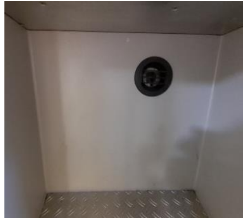
43. ábra: A mozdonykísérő lábára fűjő csatornakivezetés
