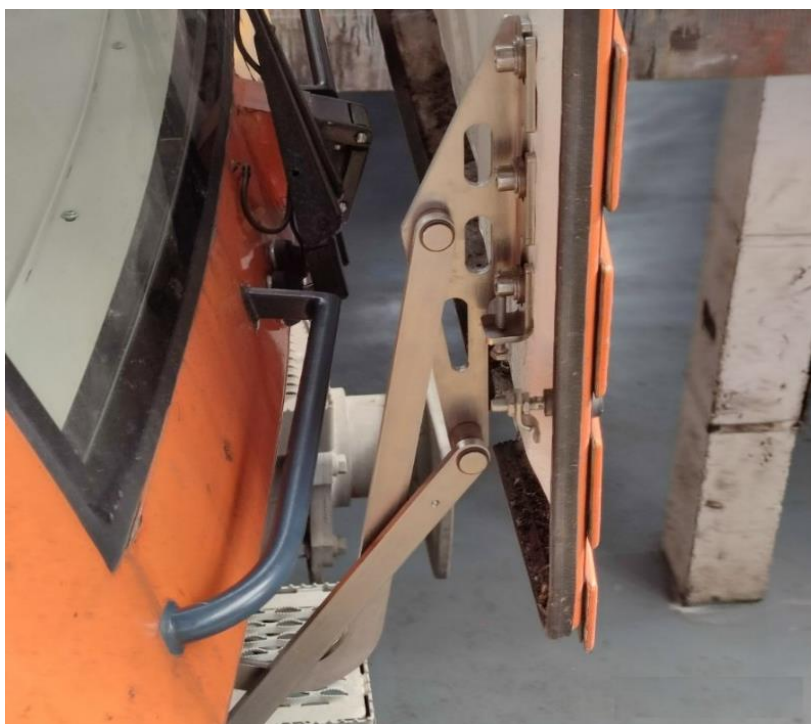
15. ábra: A Vectron mozdony orrburkolatát nyitó szerkezet
