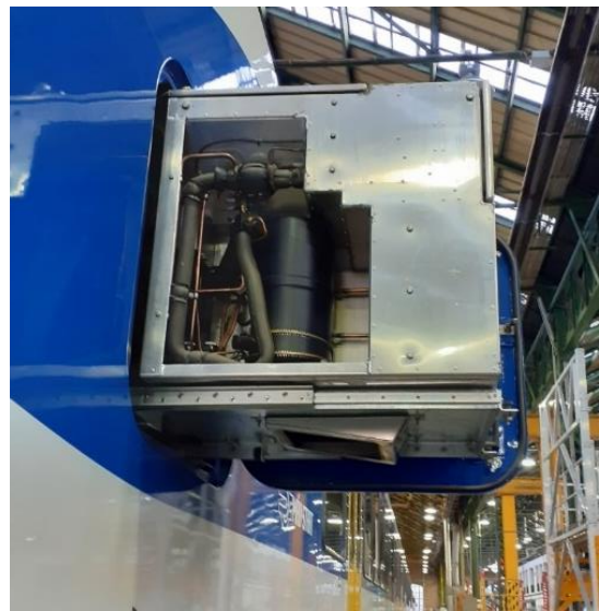
6. ábra: FLIRT motorvonat oldalra kihúzott klímaegységgel
