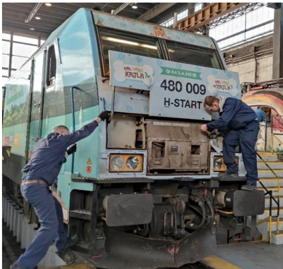
3. ábra: TRAXX mozdony kinyitott orrburkolattal
