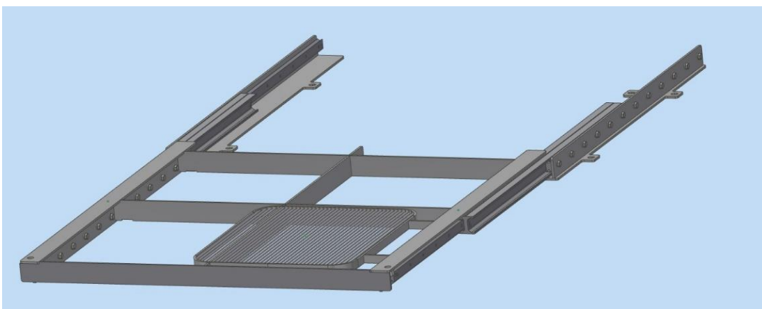
30. ábra: Kihúzott állapotban lévő fióksín a kerettel
