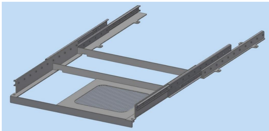
35. ábra: Kihúzott állapotban lévő keskeny fióksín a kerettel
