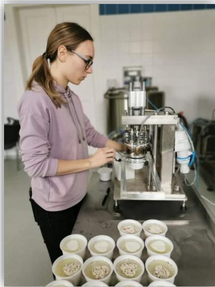
11. ábra: Alumínium fedelek hegesztése pohárfedél- hegesztő gép segítségével (saját kép)
