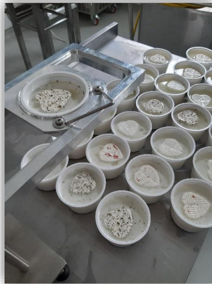
11. ábra: Alumínium fedelek hegesztése pohárfedél- hegesztő gép segítségével (saját kép)
