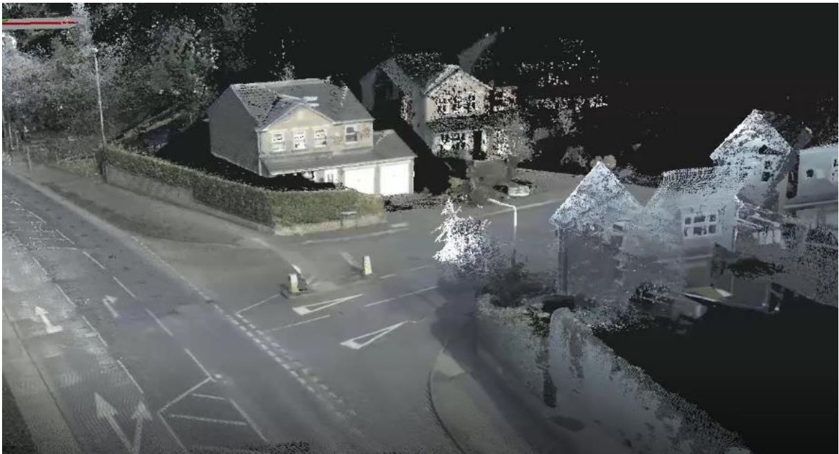
20. ábra Pontfelhő alkalmazása, már meglévő állapot felmérésére. (Forrás: Bimfra weboldal [10])
