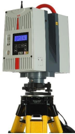
8. ábra Leica HDS6200 (Forrás Serecal weboldal [4])
