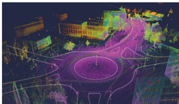
7. ábra: A Széchenyi István Egyetemen autonóm járműve és a rászerezelt LIDAR kamera képe
