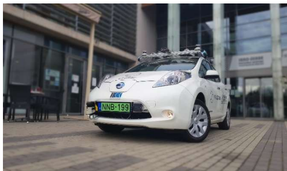
7. ábra: A Széchenyi István Egyetemen autonóm járműve és a rászerezelt LIDAR kamera képe
