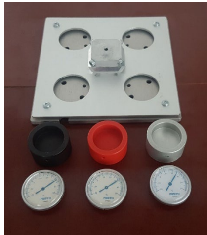
12. ábra: Palette, munkadarabok és hőmérő óralapok
