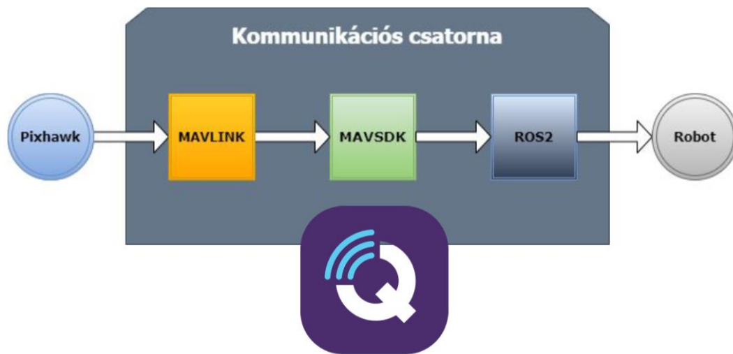
6. ábra. PX4 robotpilóta rendszer kommunikációs blokkvázlata [7]
