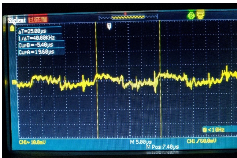
5.2.3. ábra. A megtévesztő zavar hibásan detektált ultrahang képe (látható nagy mennyiségű zavar) (saját kép)
