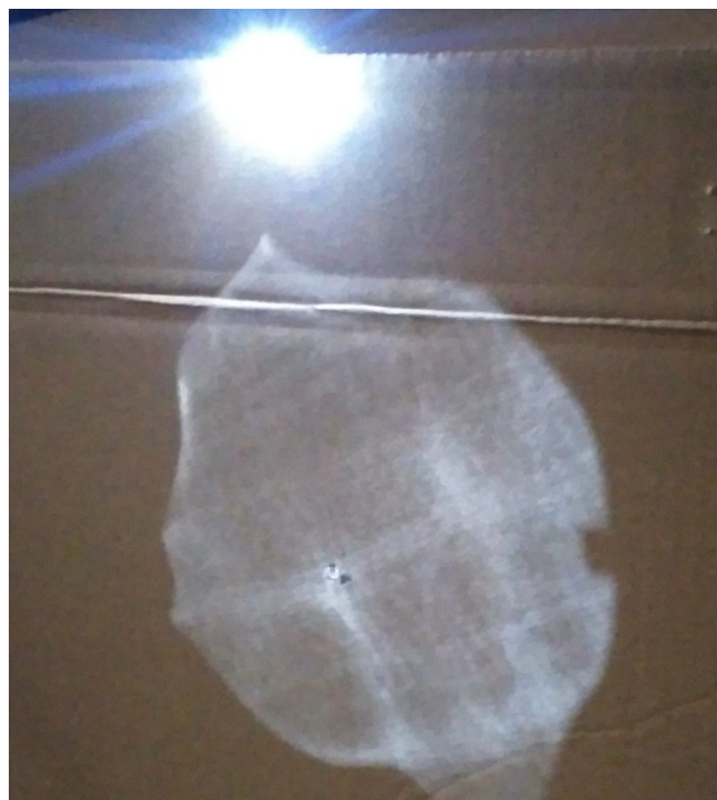
5.2.2. ábra. A Mérés közbeni kép, a tetején látható a megvilágító egység, az optika által megvalósuló kép jobb oldalán látható folt az ultrahangos adó a várható hullámok útjába pedig a fototranzisztor (saját kép)
