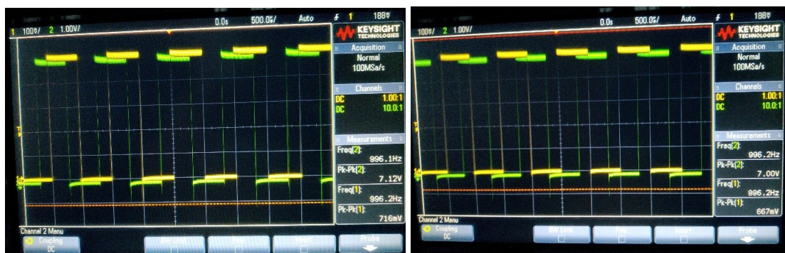
2.4.2. ábra. A zöld csatorna siet (1. kép) késik (2. kép) - a sárga referenciához képest. (saját kép)
