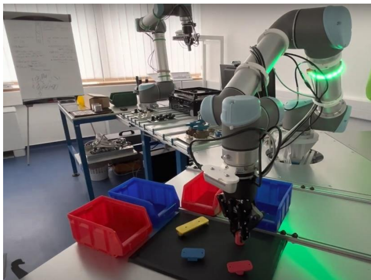
24. ábra Munkadarab megfogása
