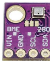
5.3 ábra: BME280-M hő, páratartalom és légnyomás szenzor
