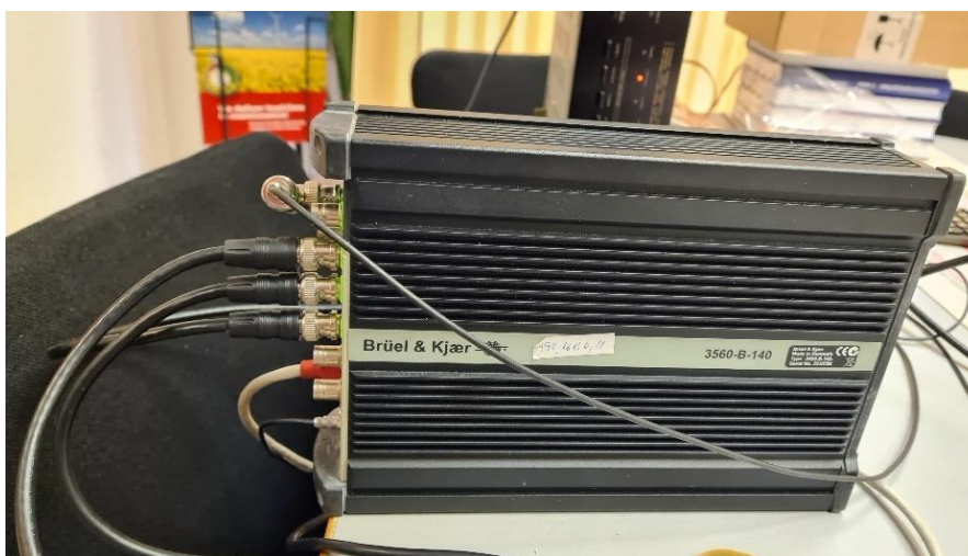
11. ábra Brüel & Kjaer PULSE 3560-B-140 mérőegység
