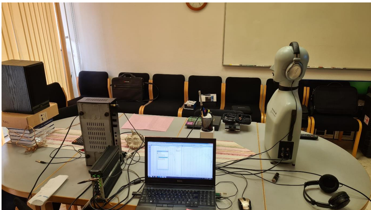
13. ábra Átviteli függvény mérési összeállítás műfejjel
