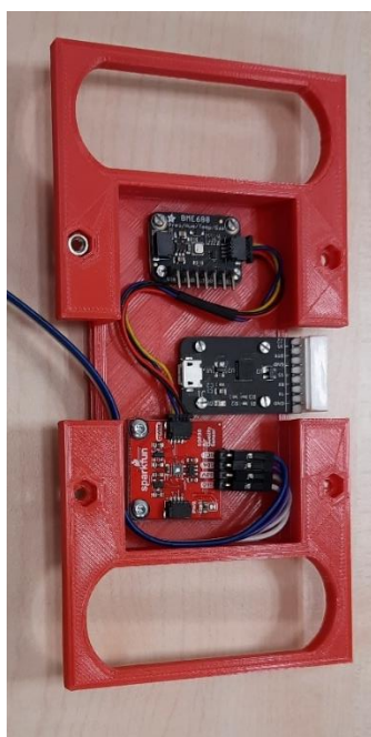
Levegő összetétel érzékelő szenzor tartó 13
