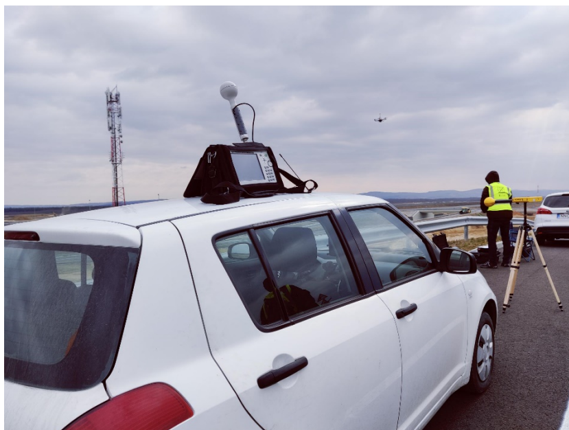
14. Ábra: Nyaláb váltás, beamsweeping vizsgálat Anritsu MS2720T és Narda SRM-3006
