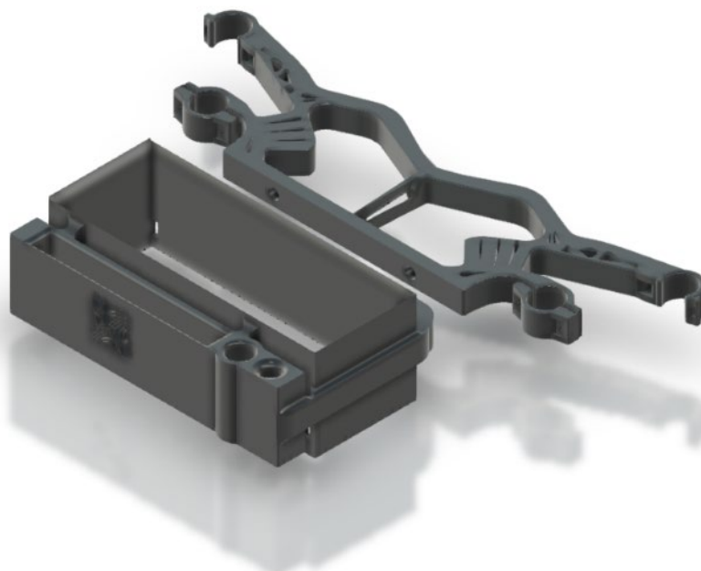
6. Ábra: 3D nyomtatott felfogató rendszer digitális terve
