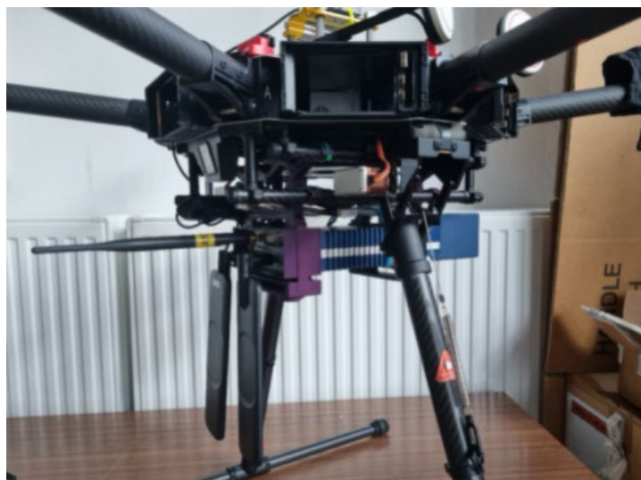
7. Ábra: Drónra felszerelt mobilhálózat mérő berendezések
