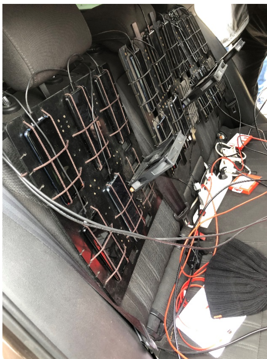
1. Ábra: Mérőtelefonok az autóban elhelyezve
