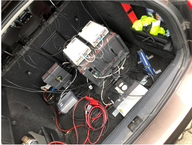
2. Ábra: Nemo Invex modul és scannerek
