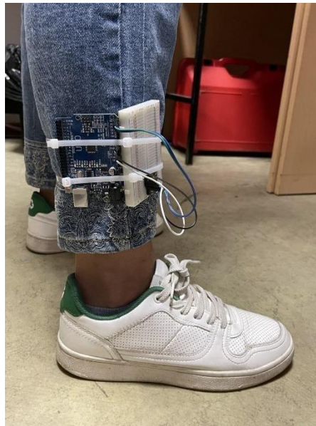
14. ábra - Arduino Uno lábra erősítése (saját)
