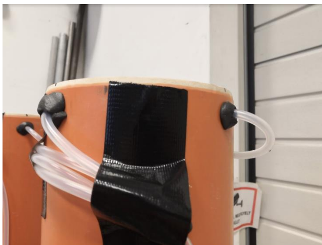
7. Ábra: A mérőperem kialakítása
