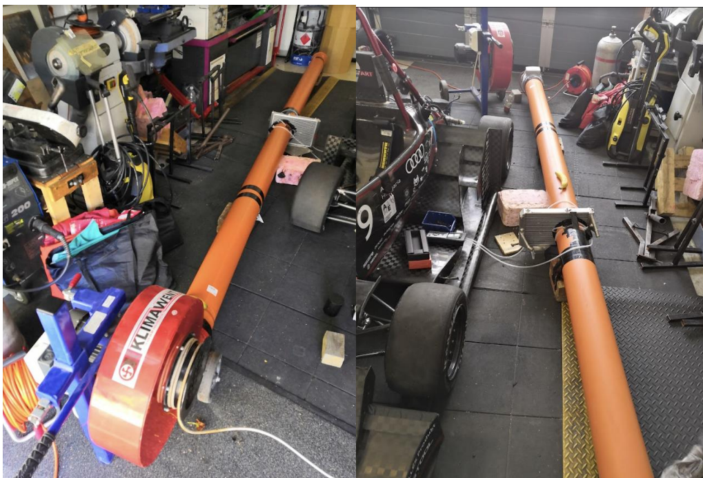
9. Ábra: A méréshez felépített szélcsatorna a két különböző ventilátorral
