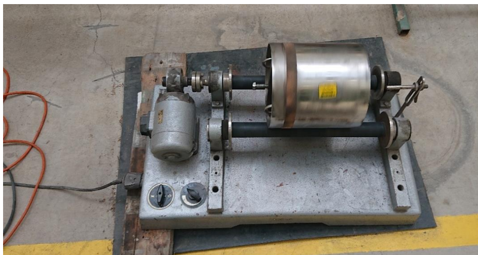
6. ábra: mikro-Deval forgódob használatban [szerző saját fényképe]
