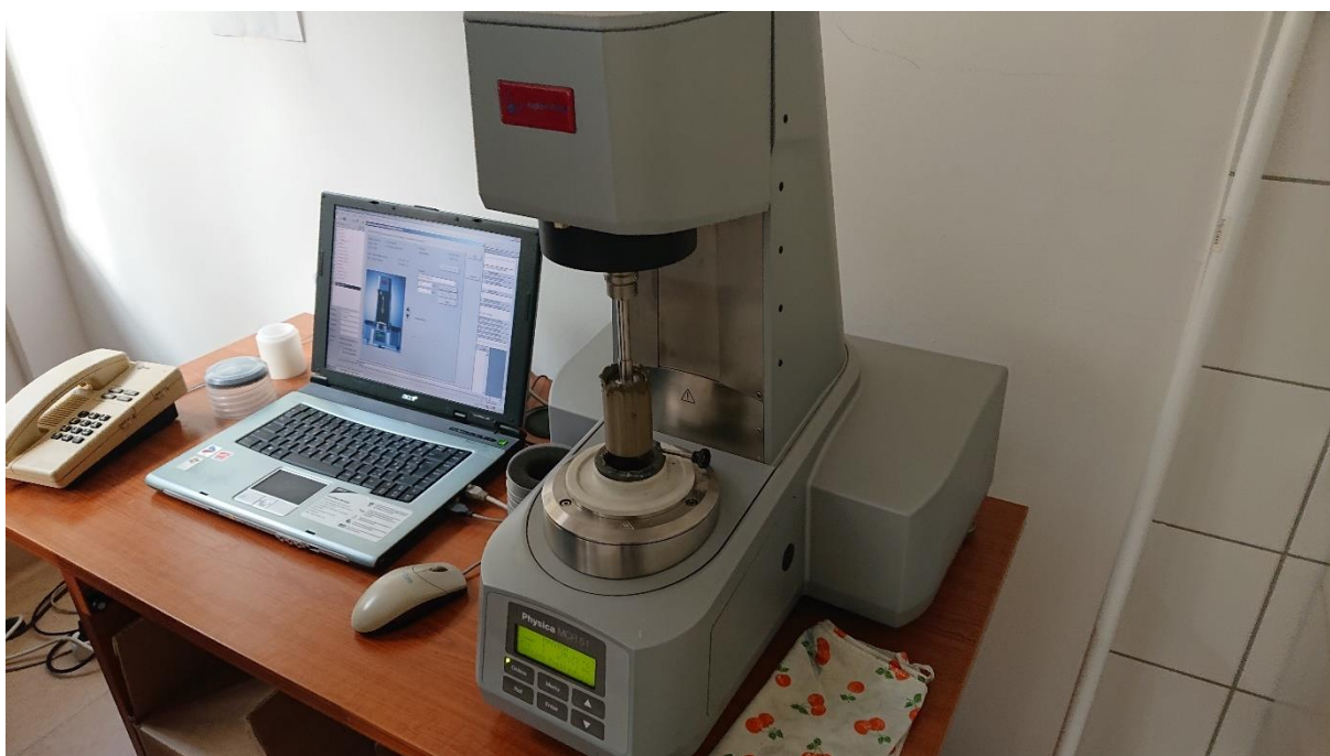
12. ábra: az Anton-Paar Physica MCR 51 használatban [a szerző saját fényképe]
