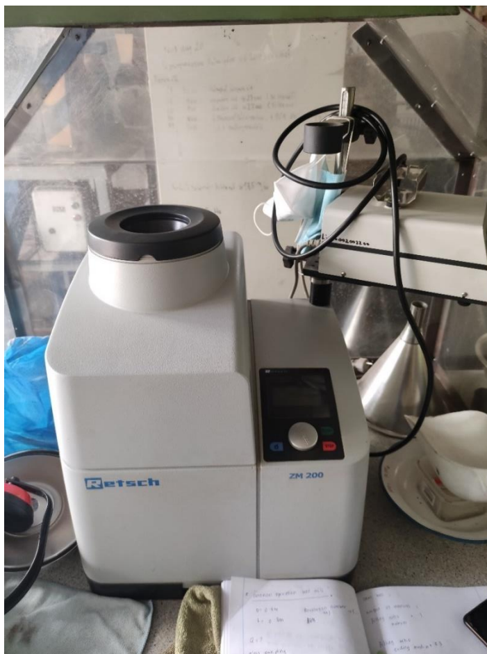
8. ábra Az NYKE Intézet RETSCH ZM 200-as nagysebességű őrőmalma
