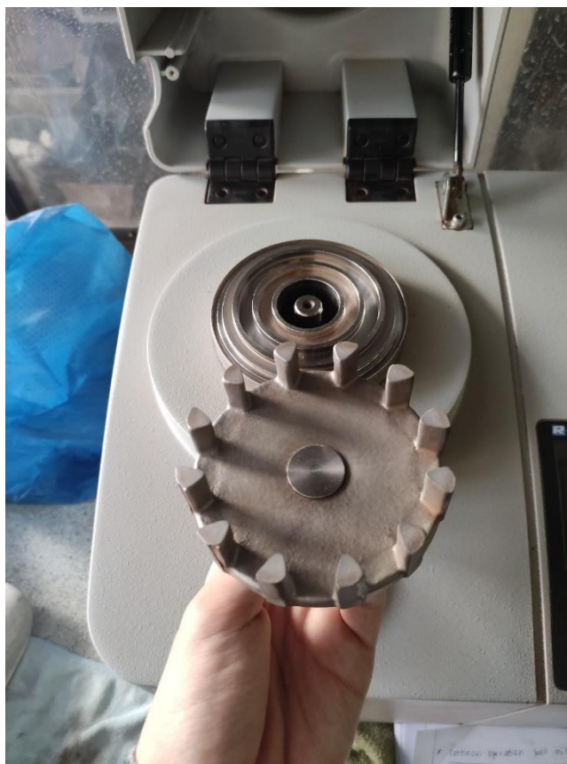
9. ábra A RETSCH ZM 200-as aprítóberendezés rotorja
