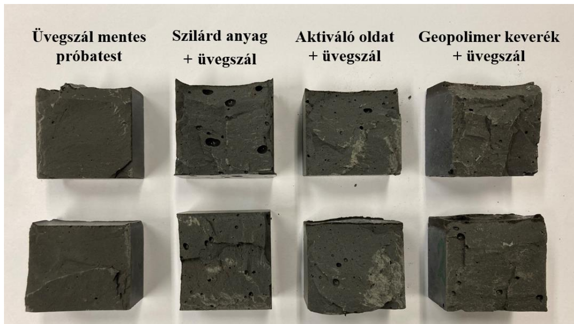
21. ábra Elterő keverési módszerekkel előállított geopolimereknél megfigyelhető, eltérő mértékű pórusképződés; a felső sorban az A oldal, az alsó sorban a B oldal
