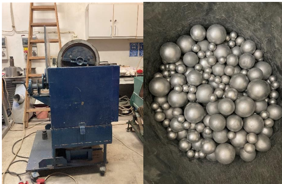
4. ábra Laboratóriumi golyósmalom működés közben (bal) és acél őrlőgolyók (jobb)
