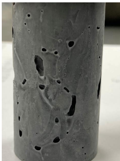
15. ábra 50 m/m% metakaolin tartalmú próbatesten megfigyelhető több milliméter nagyságú pórusok
