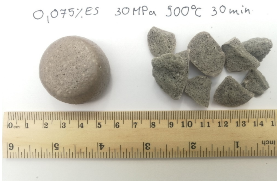
10. ábra Üveghab 0,075% ES (eggshell) habosítószerrel 30 MPa nyomáson tablettázva 900°C -onszinterezve 30 min tartózkodási idővel
