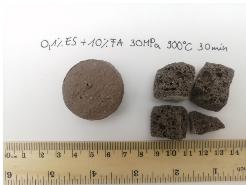
16. ábra Üveghab 0,1% ES(eggshell) habosítószerrel+ 10% FA(flyash) hozzáadásával 30MPa nyomáson tablettázva 900°C-on szinterezve 30 min tartózkodási idővel
