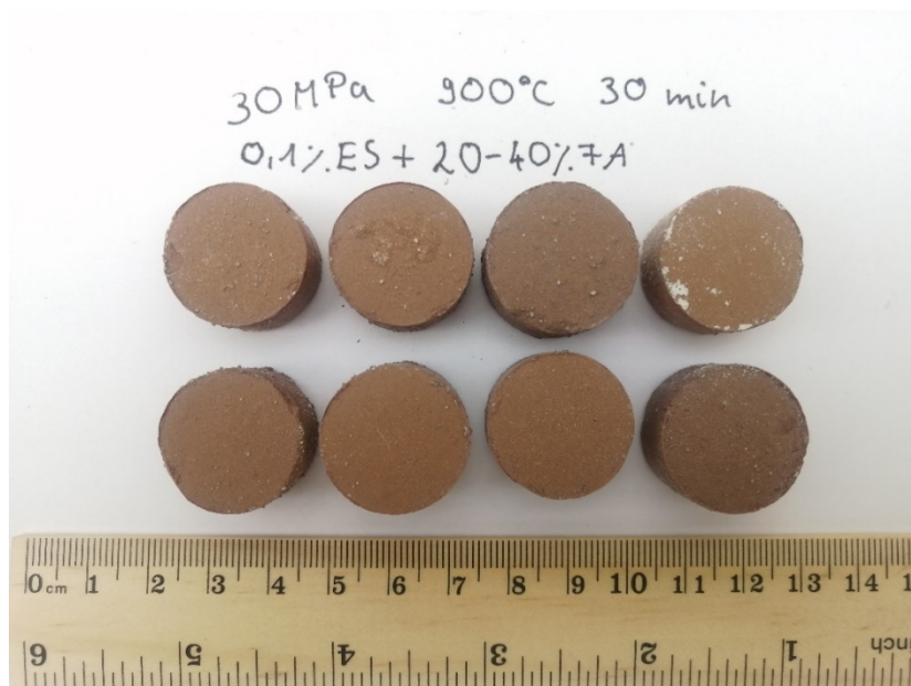
17. ábra Üveghab 0,1% ES(eggshell) habosítószerrel+ 20-40% FA(flyash) hozzáadásával 30MPa nyomáson tablettázva 900°C-on szinterezve 30 min tartózkodási idővel
