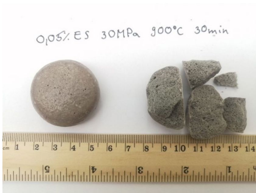
9. ábra Üveghab 0,05% ES (eggshell) habosítószerrel 30MPa nyomáson tablettázva 900°C -onszinterezve 30 min tartózkodási idővel
