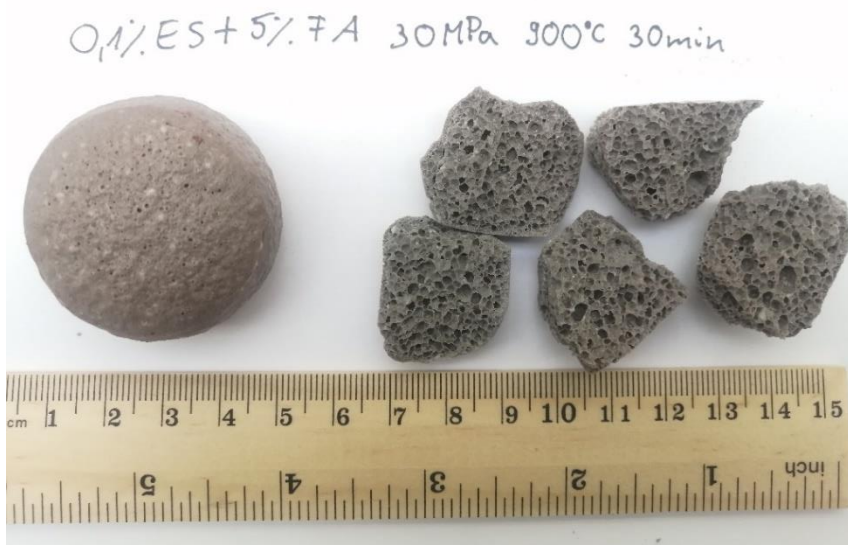
14. ábra Üveghab 0,1% ES(eggshell) habosítószerrel+ 5% FA(flyash) hozzáadásával 30MPa nyomáson tablettázva 900°C - on szinterezve 30 min tartózkodási idővel
