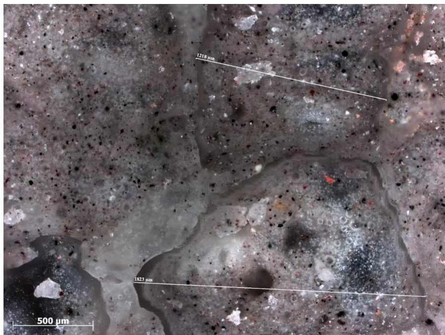
24. ábra 0,1% ES (eggshell)+5% FA(flyash) tartalmú üveghab mikroszkópos felvétele
