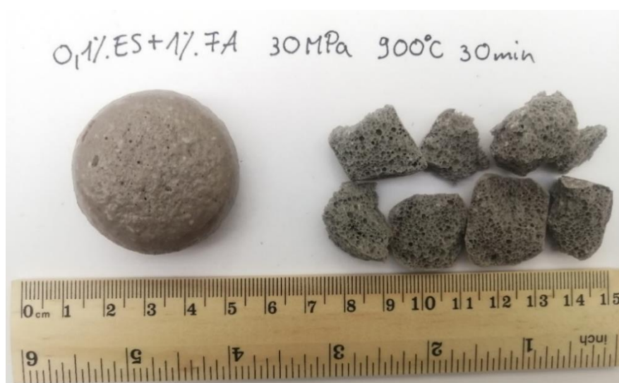
12. ábra Üveghab 0,1% ES(eggshell) habosítószerrel+ 1% FA(flyash) hozzáadásával 30MPa nyomáson tablettázva 900°C - on szinterezve 30 min tartózkodási idővel
