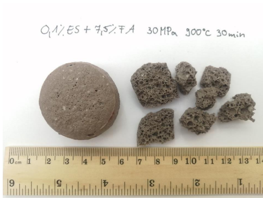
15. ábra Üveghab 0,1% ES(eggshell) habosítószerrel+ 7,5% FA(flyash) hozzáadásával 30MPa nyomáson tablettázva 900°C-on szinterezve 30 min tartózkodási idővel
