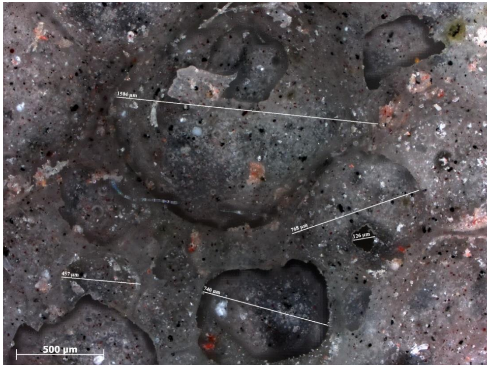
23. ábra 0,1% ES (eggshell)+3% FA(flyash) tartalmú üveghab mikroszkópos felvétele
