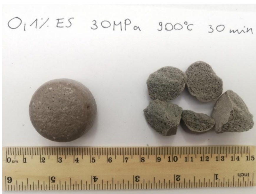
11. ábra Üveghab 0,1% ES (eggshell) habosítószerrel 30MPa nyomáson tablettázva 900°C -onszinterezve 30 min tartózkodási idővel
