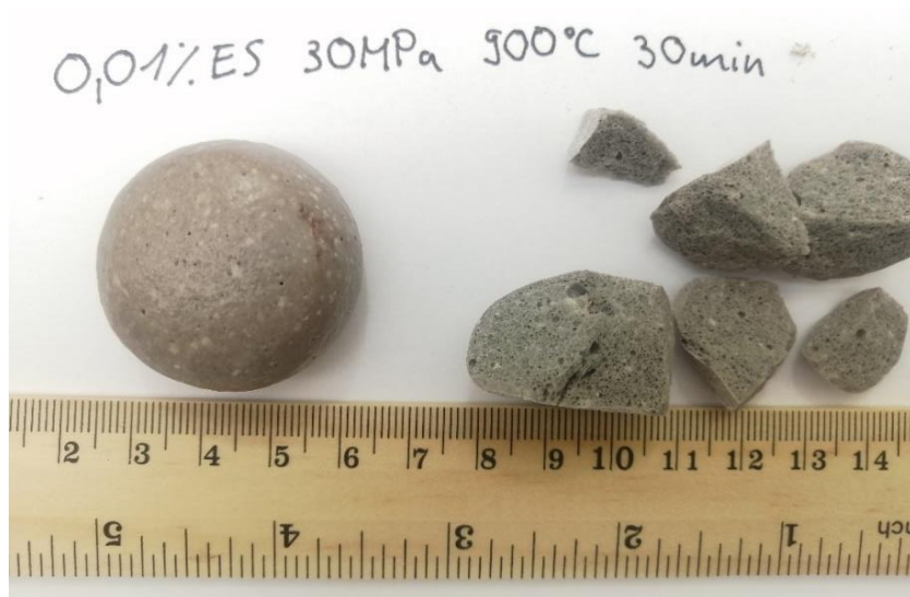
8. ábra Üveghab tabletta 0,01% ES (eggshell) habosítószerrel 30 MPa nyomáson tablettázva 900°C fokon szinterezve 30 min tartózkodási idővel
