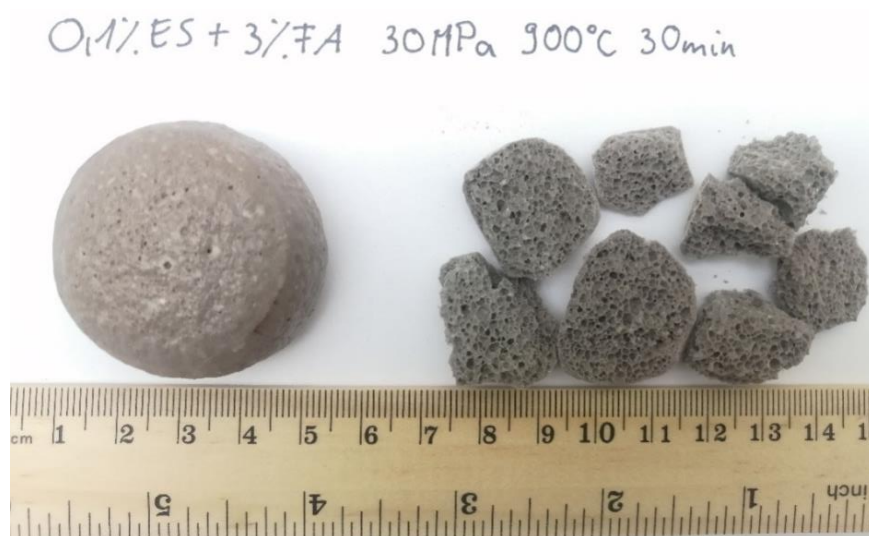
13. ábra Üveghab 0,1% ES(eggshell) habosítószerrel+ 3% FA(flyash) hozzáadásával 30MPa nyomáson tablettázva 900°C - on szinterezve 30 min tartózkodási idővel
