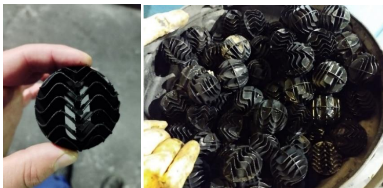
6. ábra: A tölteteken való lerakódás ellenőrzése [Saját készítésű kép].
