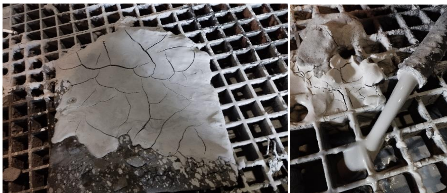
7. ábra: Az ülepítőből leválasztott iszap [Saját készítésű kép].
