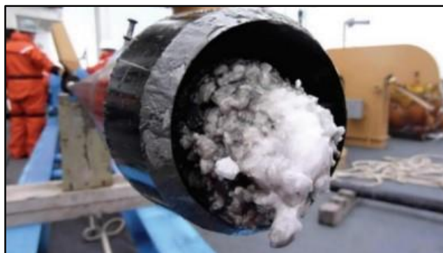
1. ábra: Gázhidrát megjelenése a vezetékben [9]
