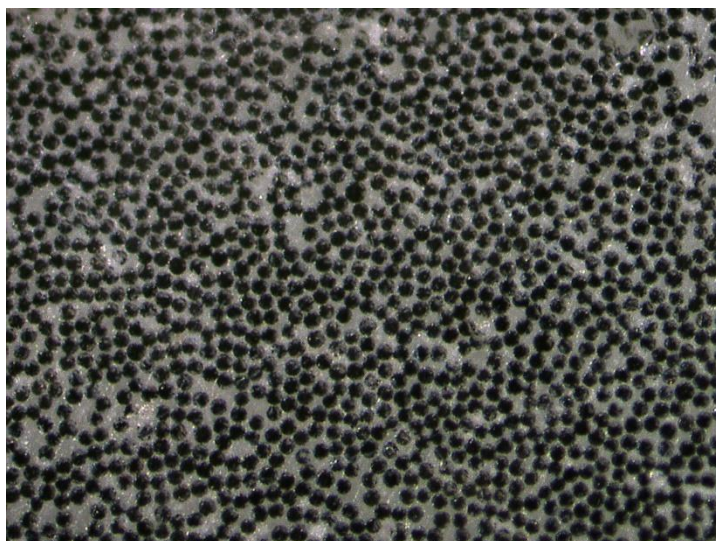
6.2. ábra. A szálszerkezetről készült mikroszkópos 336x-os nagyításban
