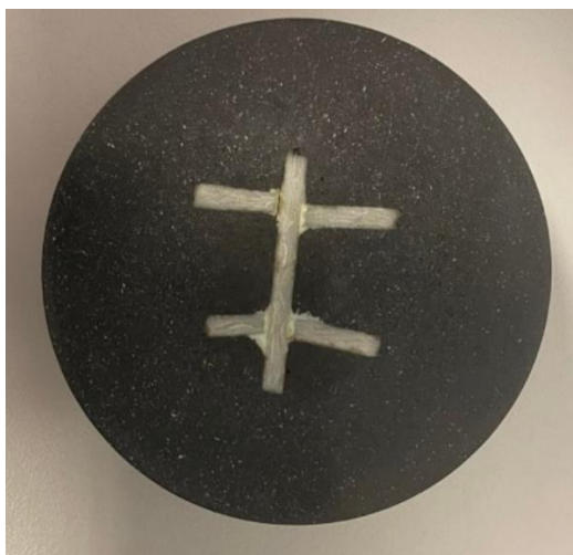
6.1. ábra. A szálszerkezet mikroszkópos vizsgálatához készített csiszolat
