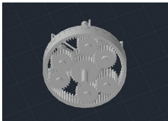
5.1. ábra: Ravigneaux-bolygómű Autocad 3D basic modell
