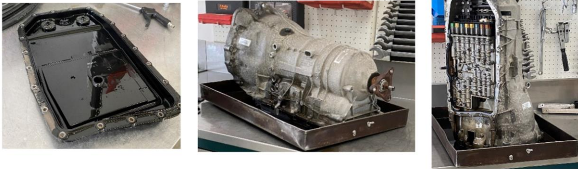
1.3. ábra: Olajszűrő (bal oldal) a teljes ZF6HP sebességváltó(középen) és a mechatronika egység (jobb oldal)
