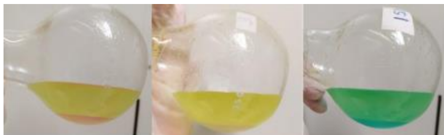
4. ábra ANA-detergens meghatározás titrálás fázisai [saját fotó]
