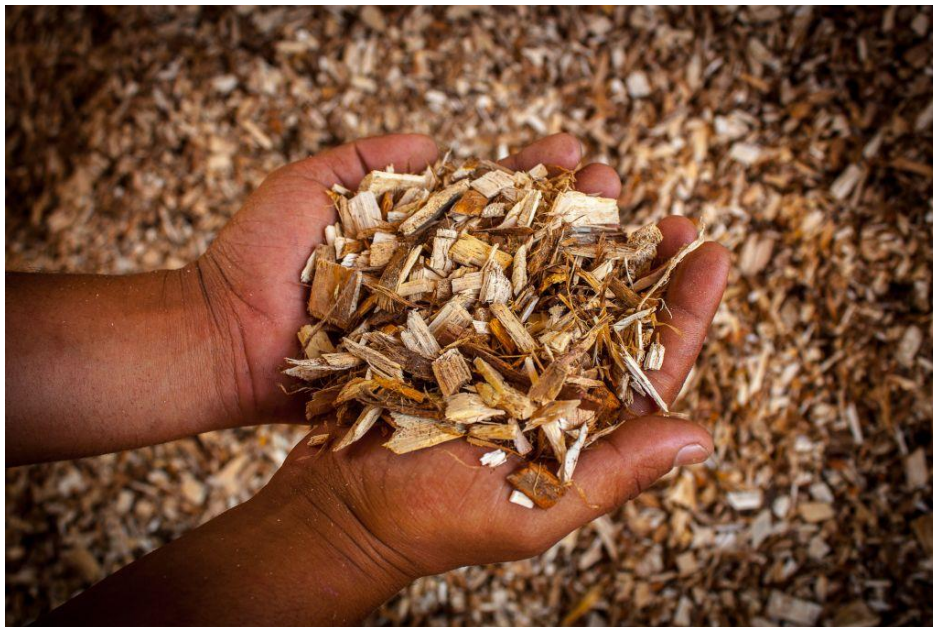
7. ábra: Szemléltető kép, a G50-es faapríték méretéről
