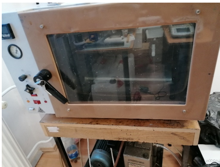
7.ábra: Kerámia és Polimermérnöki intézet szárító szekrénye. A mintákat 110^{\circ}\text{C} -on 48 órán keresztül történt a hőkezelésük.
