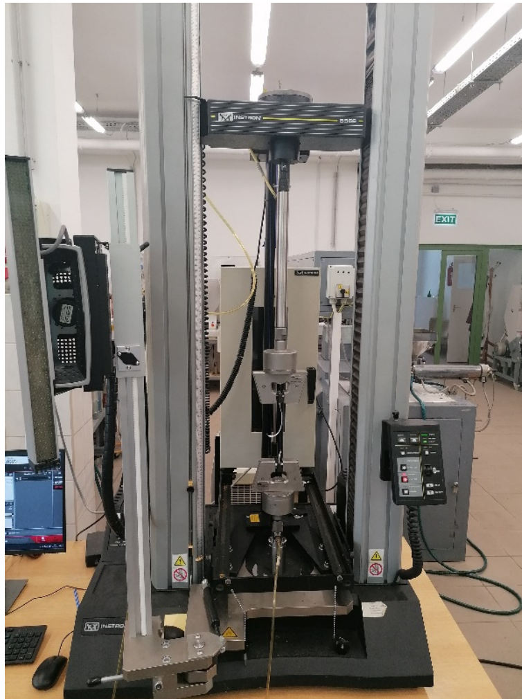
8.ábra: A mérés Instron 5566 szakító géppel lett végezve piskóta alakú próbatesteken. 50mm/perc keresztfej elmozdulási sebességgel.
