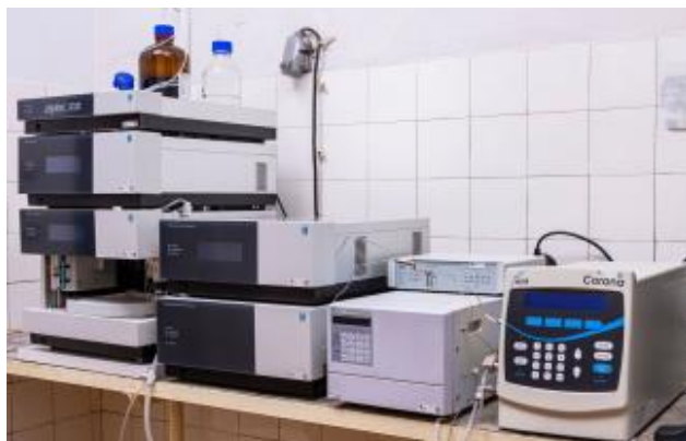
6. ábra: Corona Charged Aerosol Detektorral felszerelt Dionex Ultimate 3000 HPLC készülék [41]
