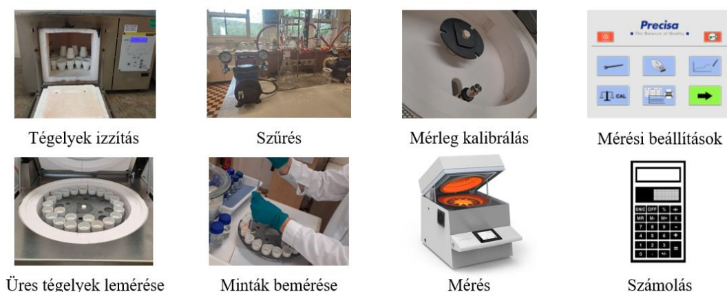
12. ábra: prepASH készülékkel történő mérés folyamatának bemutatása [1] [40]
